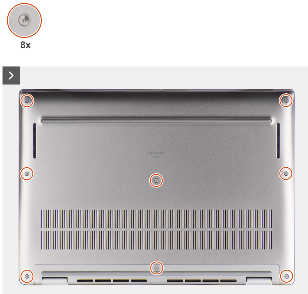
Abbildung 15. Entfernen der Bodenabdeckung
