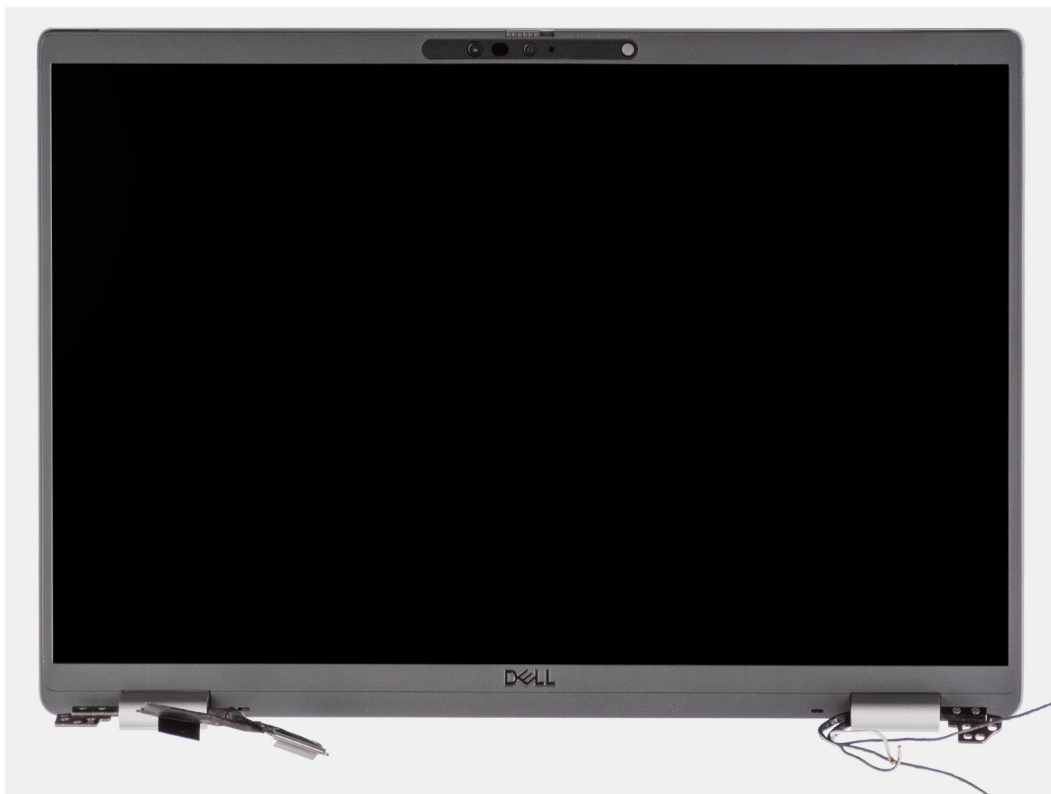
Abbildung 49. Displaybaugruppe mit WWAN-Antennenkabeln
